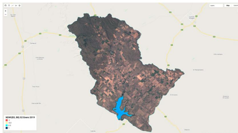
Figura 5. Ejemplo de salida GEE para el procesado *ND* en Enero de 2019 con Sentinel-2. El umbral de “celda mojada” usado es 0,5 y se ajusta a la de superficie AVE de 31,6 km<sup>2</sup> con un error de 3,8%
