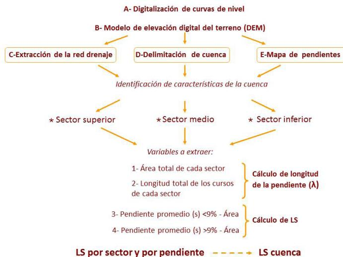
Figura 1. Esquema de la metodología implementada para el cálculo del factor de longitud y gradiente de la pendiente (LS) de la Ecuación Universal de Pérdida de Suelo Modificada
